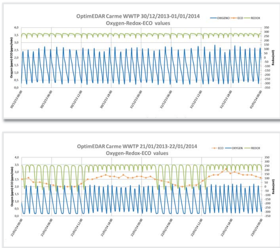
Figura 3. Evolución del Oxígeno y RedOx en el reactor biológico de la EDAR de Carme antes (arriba) y después (abajo) del control OptimEDAR
